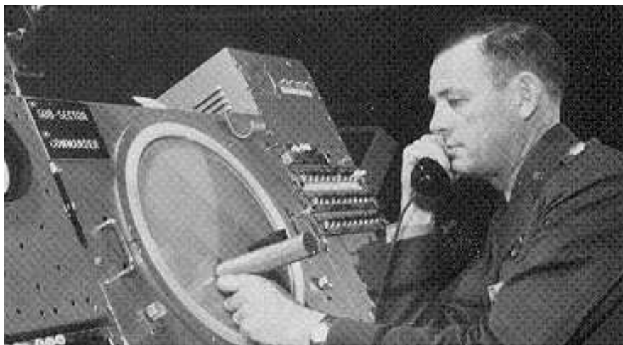
RYSUNEK A.1.1. Whirlwind – pierwszy komputer z graficznym wyświetlaczem wektoroskopowym. Źródło: [27]
