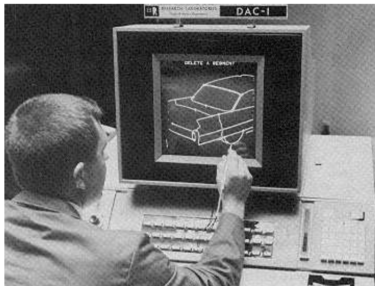
RYSUNEK A.2.1. DAC-1, pierwszy komercyjny program CAD opracowany w IBM w latach 1959-1963. Źródło: [27]
