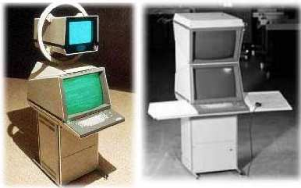
RYSUNEK A.13.1. Z lewej: system firmy M&S COMPUTING (z monitorem katodowym) przystosowany do wyświetlania grafiki. Z prawej: dwumonitorowa stacja Intergraphu w jednej obudowie. Źródła: www.intergraph.com/ingrhistory.htm , www.intergraph.com/ingrhistory70s.htm
