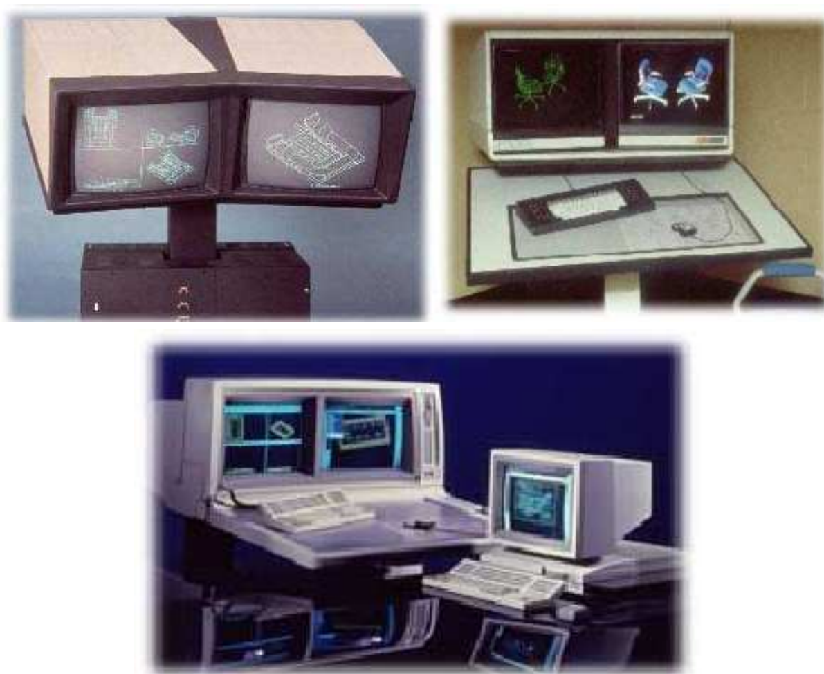
RYSUNEK A.13.2. Dwumonitorowe stacje Intergraphu z 1980 r., z 1982 r. z tabletem oraz modele InterAct i InterPro z r.1983 wg www.intergraph.com/ingrhistory.htm
