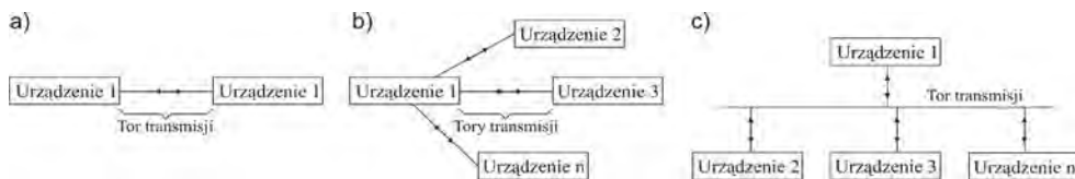
Rys.3.34.Układy wymiany danych: a) przy połączeniu punkt-punkt, b) przy połączeniu punkt-wielopunkt, c) przy połączeniu za pomocą magistrali, wg [20]
