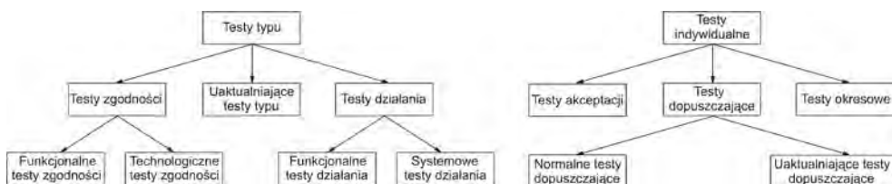
Rys.12.1. Podział testów cyfrowych urządzeń zabezpieczeniowych, wg [40]
