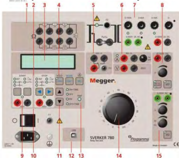
Rys. 12.8. Płyta czołowa testera SVERKER 750/780 [15]. Oznaczenia: 1 -zestaw rezystorów do dokładnej regulacji prądu i napięcia,2-wejścia stopu i startu sekundomierza,3-wyświetlacz wartości mierzonych i nastawianych,4-funkcja zatrzymanie odczytu na wyświetlaczu,5-zestyk zwierno/ rozwierny (zmienia automatycznie stan gdy test jest uruchomiony),6-ampereomierz i woltomierz,7-źródło prądu i napięcia,8-dodatkowe źródło napięcia stałego,9-wskaźnik stanu,10-wejście sekundomierza (do pobudzeń zewnętrznych i wewnętrznych),11-przełącznik uruchomienia trybu pracy 12-wejście komunikacyjne USB,13-wskaźnik pobudzenia,14-główne pokrętko do ustawiania wartości wyjściowych napięcia i prądu,15-źródło napięcia przemiennego z regulacją w zakresie 0-230 V AC z ustawionym kątem fazowym i częstotliwością
