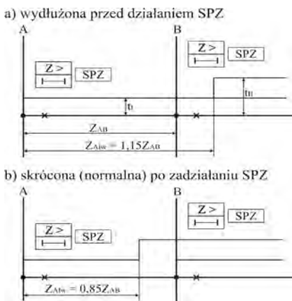
Rys. 10.7. Zasada skracania wydłużonych pierwszych stref działania zabezpieczeń odległościowych współpracujących z automatyką SZR w liniach promieniowych
