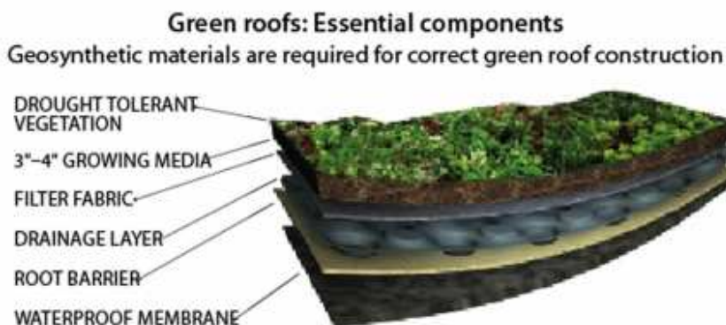
Rys. 81. Typowy przekrój zielonego dachu
