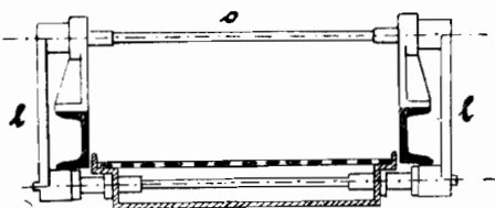
Rys. 15*. Schemat przesiewacza podłużnego (angielskiego). Przekrój poprzeczny.
