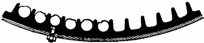
Rys. 199**. Młyn stożkowy Hardinge. Ścianka wewnętrzna.
