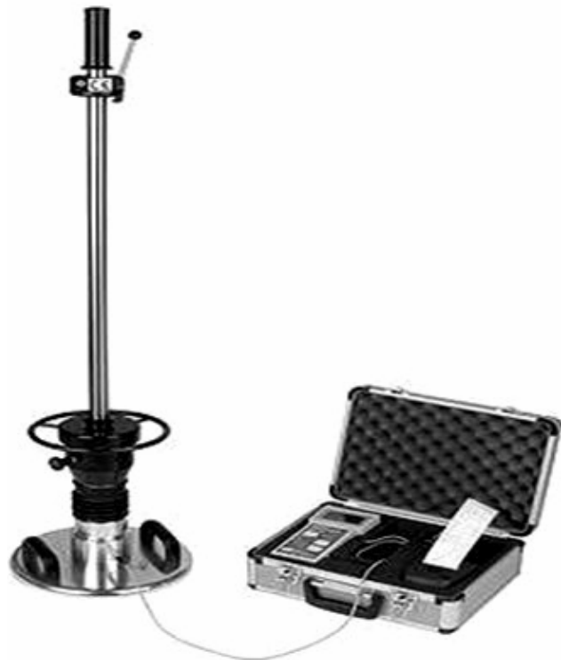
Rys. 7. Widok ogólny lekkiej płyty dynamicznej LFG
