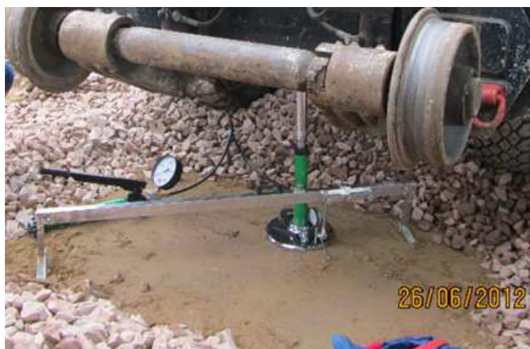
Rys. 1. Płyta VSS w trakcie badań
