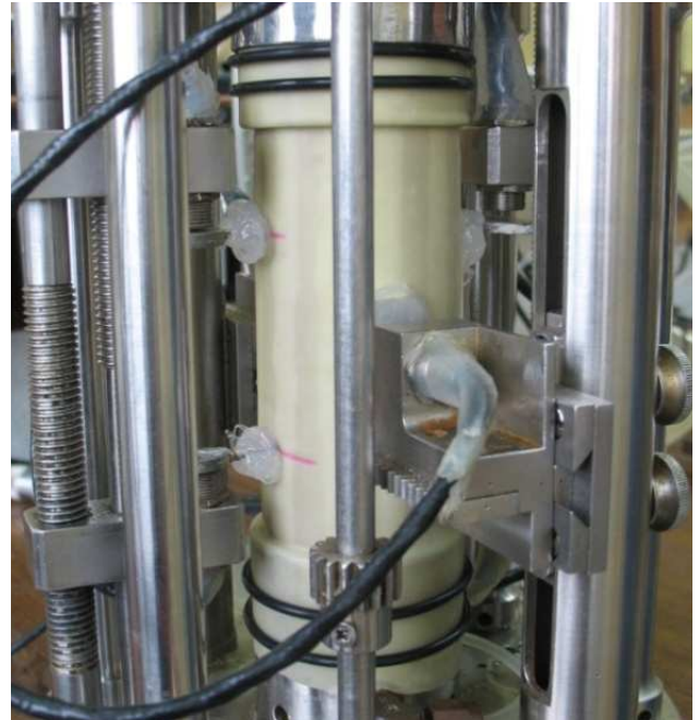
Rys. 7. Przykład montażu czujników zbliżeniowych (Politechnika Śląska)
