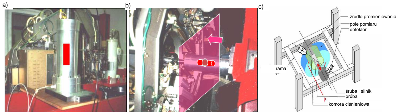
Rys. 8. Tomotriax: a) komora aparatu trójosiowego z zaznaczoną próbką, b) komora trójosiowa przygotowana do badania w skanerze RX z zaznaczoną próbką i kierunkiem skanowania, c) schemat Tomotriaxu
