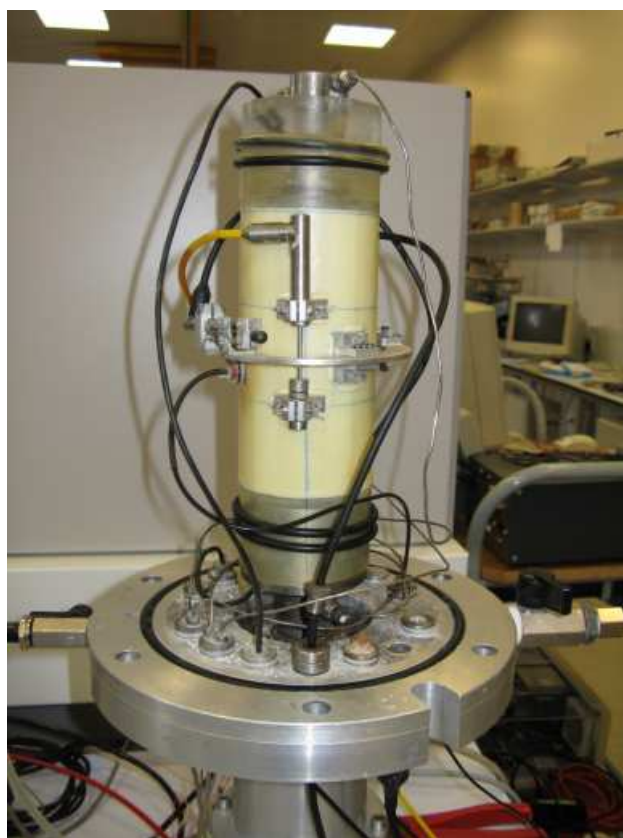
Rys. 1. Przykład montażu czujników LVDT (Uniwersytet Bristolski)
