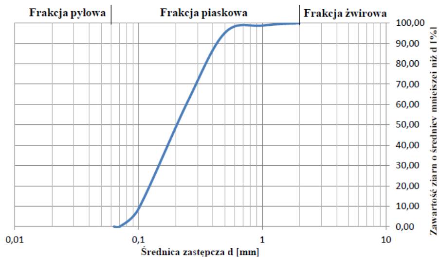
Rys. 4. Krzywa uziarnienia badanego gruntu
