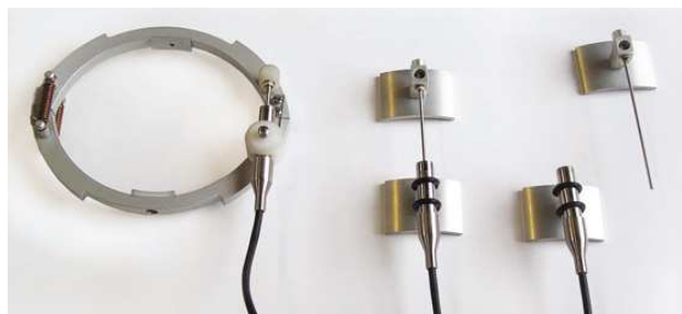
Rys. 2. Uchwyty montażowe (Politechnika Śląska)
