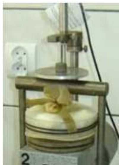
Rys. 3. Widok edometru z próbką iłu zabezpieczoną lateksową membraną
