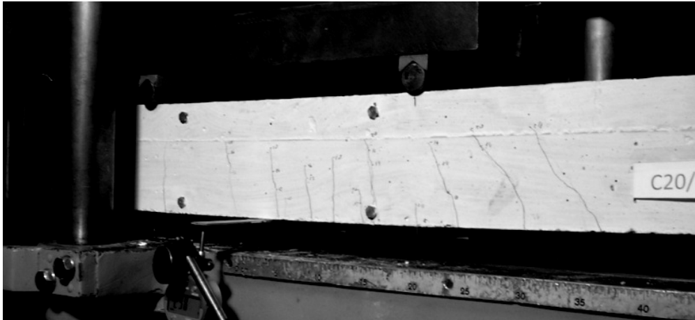
Rys. 6. Dokumentacja zarysowania po zniszczeniu belek jednorodnych wykonanych całkowicie z betonu zwykłego – seria N
