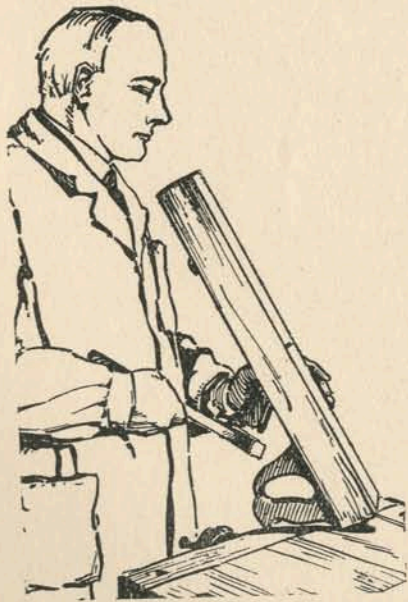
Rys. 26. Nastawianie noża w strugu spustnika.
