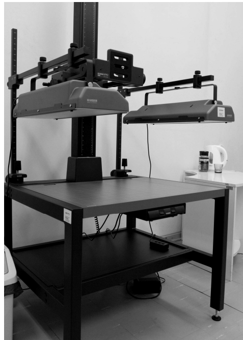
Fot. 3. Stanowisko do skanowania przy użyciu aparatu cyfrowego (fot. Paweł Dąbrowski)
