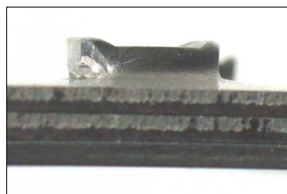
Rys. 2. Trójwarstwowe (prostokątne) złącze stalowych blach z nacięciem materiału
