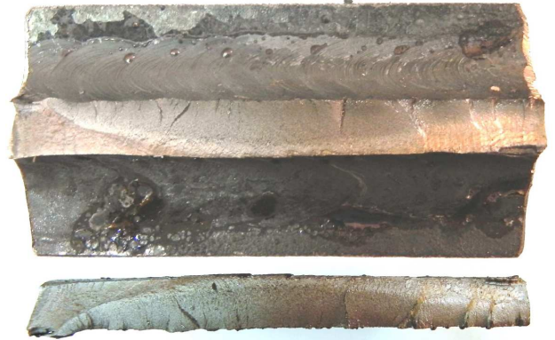
Rys. 7. Zdjęcia przełomu zmęczeniowego
