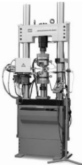
Rys. 2. Maszyna wytrzymałościowa MTS 809
