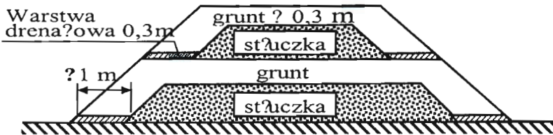
Rys. 1. Schemat wykorzystania stłuczki szklanej w konstrukcji nasypu wg [7]
