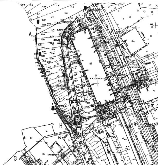
Rys. 4. Lokalizacja węzłów sondowania statycznego
