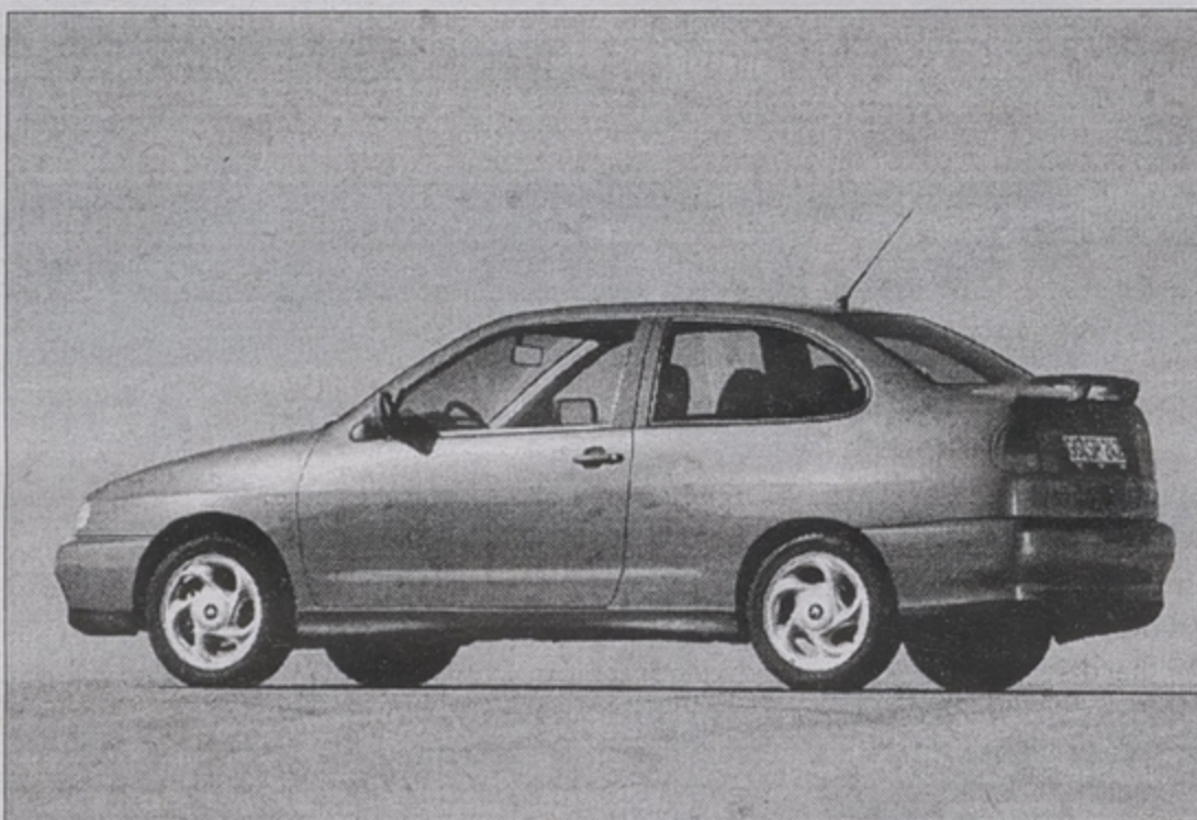
Wysoko przebiegająca linia pokrywy bagażnika jest kompromisem między kształtem tylnej partii nadwozia i pojemnością przestrzeni ładunkowej
