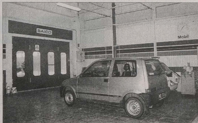
W warsztacie blacharsko-lakierniczym zainstalowana jest nowoczesna, ekologiczna komora firmy SAICO
