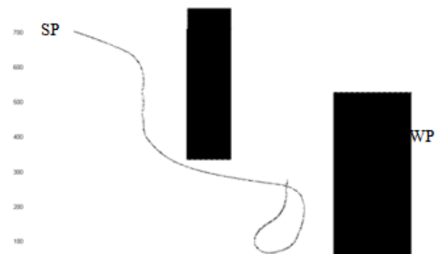
Rys. 23. Trajektoria lotu mikrosamolotu w pierwszej symulacji zadania omijania przeszkody. Początkowy kurs – 250, punkt startu SP – x=100, y=700 , kolejny punkt przelotowy WP – x=900, y=200
