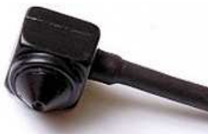
Rys. 4. Miniaturowa kamera LC-S762 z przetwornikiem SONY o czułości 0,05 lux, rozdzielczości 420TVL, trybie pracy dzień/noc
