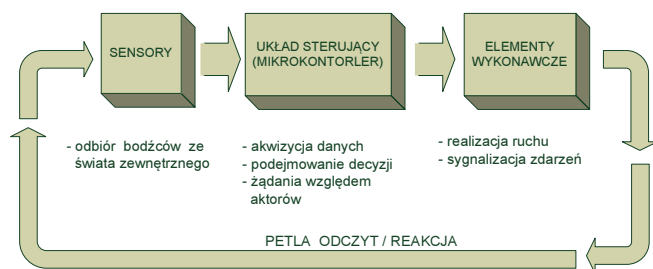
Rys.1. Pętla odczytu sensorów i wynikowej reakcji silników
