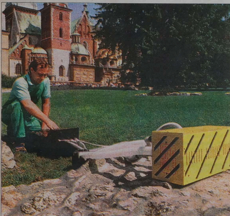
Na wawelskim wzgórzu pokazano nowe urządzenie do osuszania murów przy pomocy fal wysokiej częstotliwości. Na zdjęciu: Pokazowa obsługa nowego urządzenia.
