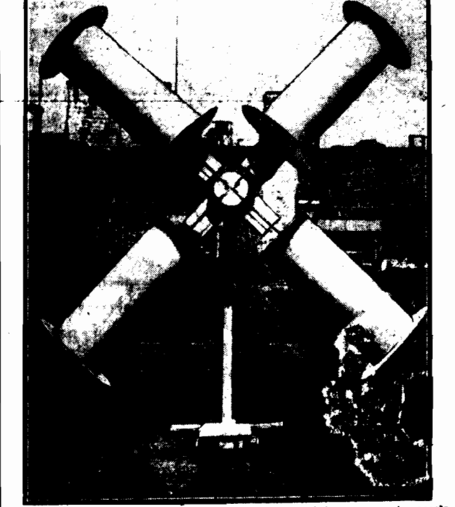
Pewna fabryka nowojorska zbudowała wiatrak, którego skrzydła zamiast zwyczajnych śmigieł mają wałce rotacyjne. Opiera się on na tej samej zasadzie, co głośny w swoim czasie wynalazek Fletnerowskiego statku rotacyjnego.
