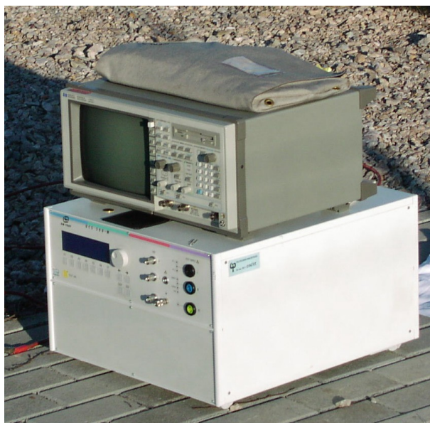
Rys. 5.6. Generator UCS 500-M oraz oscyloskop HP 54522A wykorzystywane do badań terenowych w stacjach bazowych (po lewej); Pomiar prądu udarowego w przewodzie uziemiającym pierścienia wyrównawczego w kontenerze (po prawej)
