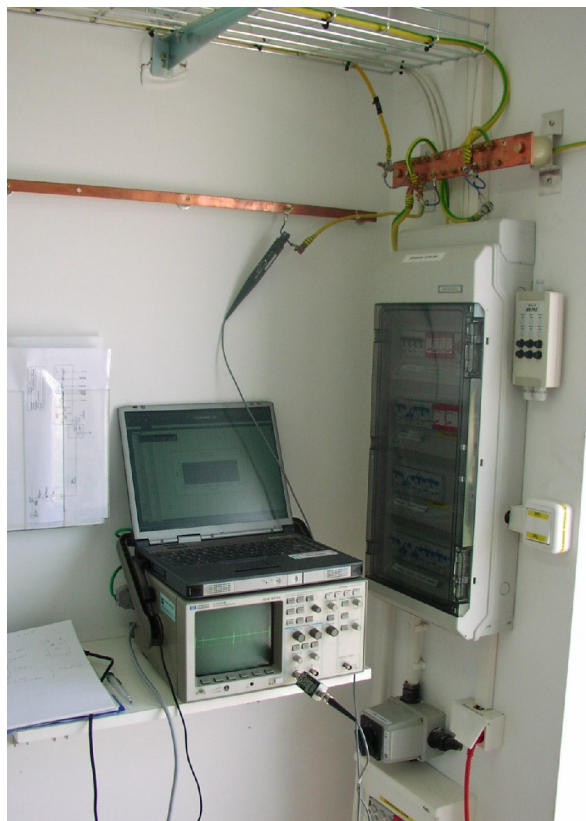
Rys. 5.6. Generator UCS 500-M oraz oscyloskop HP 54522A wykorzystywane do badań terenowych w stacjach bazowych (po lewej); Pomiar prądu udarowego w przewodzie uziemiającym pierścienia wyrównawczego w kontenerze (po prawej)
