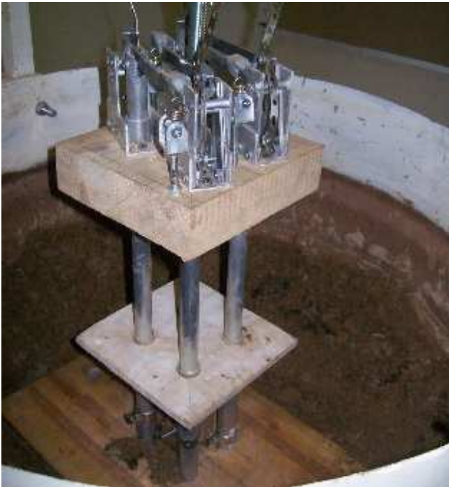
Rys. 3. Model fundamentu płytowo-palowego w czasie kalibracji
